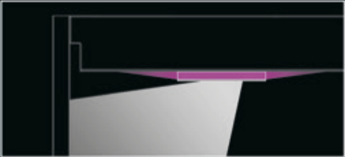
Secção vertical wallwasher LD7-LED-RGB Esquema funcional iluminação direta e indireta
